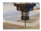
**Механическая обработка:** При резании оргстекла, фрезеровании или сверлении следует подбирать режим работы инструмента избегая высоких оборотов, приводящих к перегреву режущего инструмента и материала с налипанием стружки на инструмент. Допустимо сопровождать резку подачей воды на инструмент для его охлаждения и смазки.
