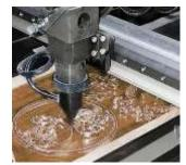
**Лазерная обработка**: При правильно подобранном режиме работы СО-лазера, обрабатываемые поверхности могут иметь глянцевую, ровную поверхность не требующую дополнительной обработки и полировки. Если нет необходимости в таком качестве, например при раскрое листов на заготовки, то скоростной режим и мощность лазера можно увеличить, сократив время обработки. Следует помнить, что после лазерной резки, на обработанных поверхностях изменяются молекулярные связи, приводящие к
