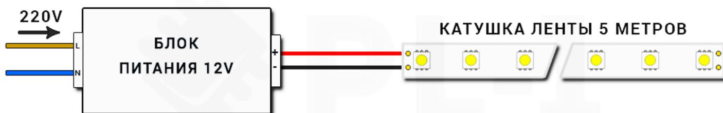
Входные провода блока питания (коричневый, синий) подключаются к сети 220В. Выходные провода подключаются к светодиодной ленте. При подключении ленты к блоку питания важно соблюдать полярность: плюс к плюсу, минус к минусу. На шлейфе ленты всегда есть обозначение полярности, провода на катушках с лентой так же маркированы цветом: красный – плюс, черный – минус. Если перепутать полярность – лента работать не будет.
