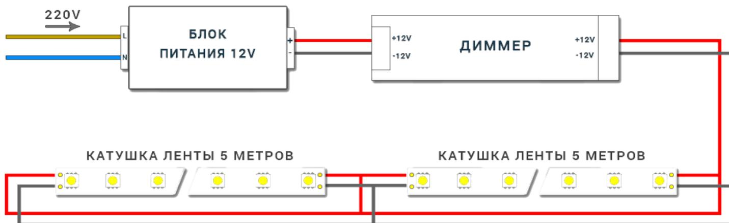
Мощность диммера должна быть достаточной для подключения необходимого количества ленты. Если же мощность диммера меньше суммарной мощности подключаемой ленты – необходимо использовать усилитель.
